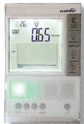
Figure 3-13: Ecometer, compteur intelligent du projet Carbon Trust
